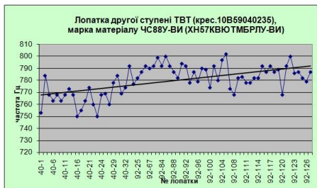
Рис.4 Діаграма частотного контролю лопаток другої ступені ТВТ ГТД-10В виготовлених з і ЧС88У-ВИ праворуч.
