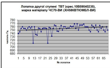
Рис.3 Діаграма частотного контролю робочих лопаток другої ступені ТВТ ГТД-10В виготовлених з ЧС70-ВИ.
