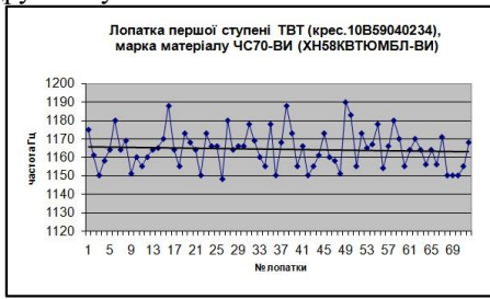
Рис.1 Діаграма частотного контролю лопаток першої ступені ТВТ ГТД-10В виготовлених з ЧС70-ВИ.
